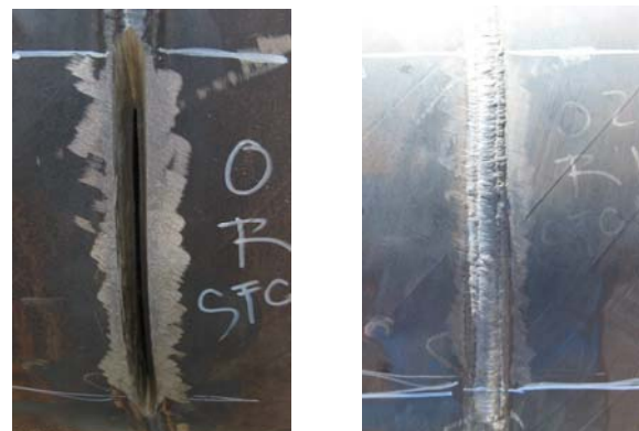
Bild 7: Simulation einer Nahtreparatur
